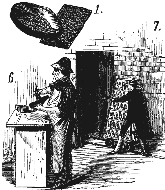
1) Кусокъ сырой резины. 6) Лакированіе готовыхъ калошъ. 7) Тачка для перевозки калошъ въ печь.
