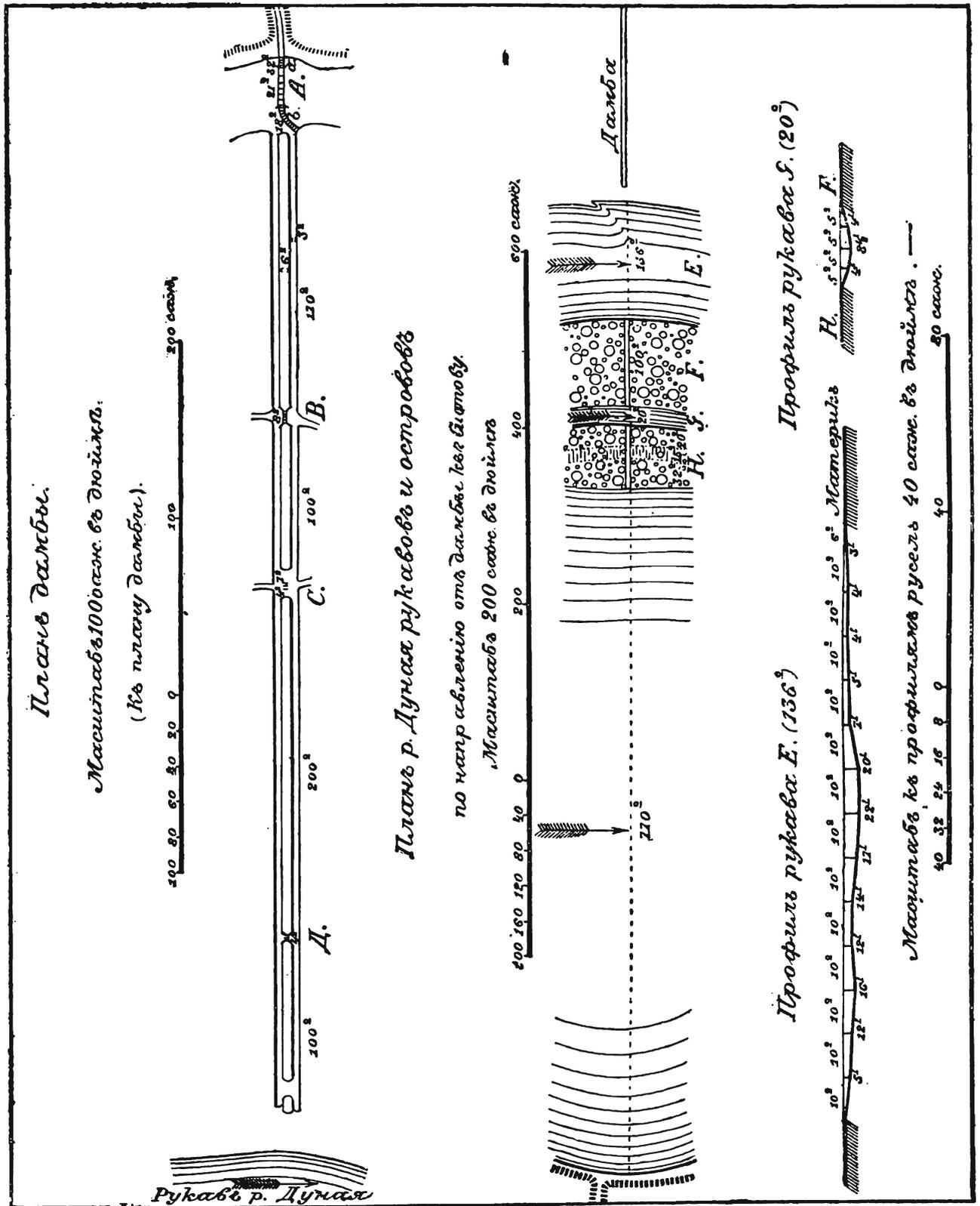
устоевъ въ разстояніи 2 саж. одинъ отъ другого; каждый устой изъ 4 свай, соединенныхъ насадкой; остальные части моста разобраны и разрушены. 3-й участокъ дамбы: насыпь длиною около 200 саж. и шириною 1 саж.; у моста *C* размыта на 3 саж. (4 саж. воды), а у моста *D* на 5 саж. Мостъ
