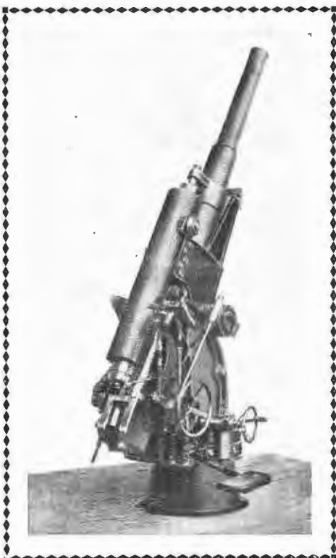
Пушка для стрѣльбы по воздушнымъ шарамъ, завода Круппа, калибромъ въ 75 миллиметровъ, на крѣпостномъ лафетѣ.
