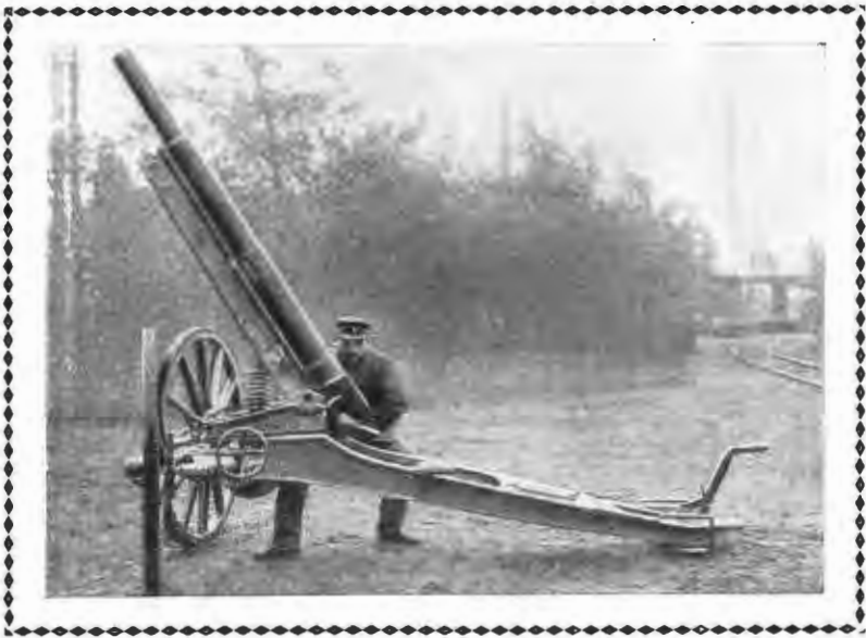
Пушка для стрѣльбы по воздушнымъ шарамъ, завода Круппа, калибромъ въ 65 миллиметровъ, на полевомъ лафетѣ.
