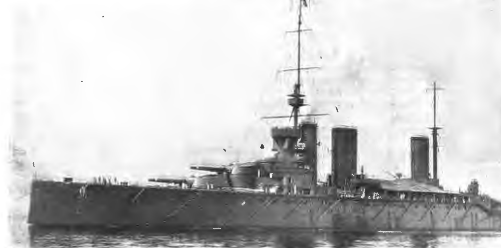
Броненосный крейсеръ сверх-дредноутъ „Кюинъ Мери“ („Королева Марія“). Длина—95 сажень; скорость хода—28 узловъ (около 50 верстъ) въ часъ. Вооруженъ, какъ и остальные крейсера, восьмью 13 \frac{1}{2} -дюймов. пушками, каждый снарядъ которыхъ вѣситъ 21 пудъ.
