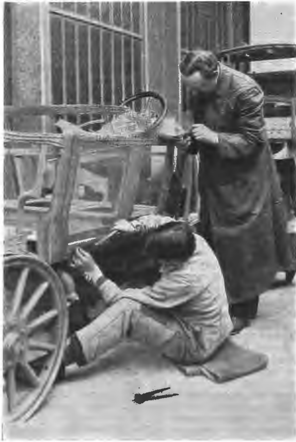
Автомобильные кузова из бетона. Последней новинкой в области автомобильной промышленности являются автомобильные кузова, обшитые вместо обычного листового железа особым цементно-бетонным составом. Остов кузова обивается легкой проволочной сѣткой, поверх которой накладывается бетонная мастика, скоро затвердѣвающая. Бетонные кузова не только легче и прочнѣе желѣзныхъ, но и красивѣе ихъ, такъ какъ допускаютъ скульптурную обработку. По фот. С. Левковича, въ Парижѣ.
