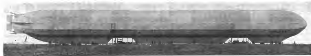
Первый французскій дирижабль „Шписсъ“ (Spiess) твердаго типа, на подобіе нѣмецкаго Цеппелина, сооруженный Обществомъ „Зодиакъ“ и носящій имя своего строителя эльзасца М. Шписса, перваго пропагандиста во Франціи твердой системы дирижаблей. Дирижабль „Шписсъ“—110 метровъ длины и 13 1/2 метр. ширины, емкостью—12.000 куб. метр., снабженный четырьмя пропеллерами, размѣщенными съ обѣихъ сторонъ, и моторомъ въ 360 лошадиныхъ силъ—произвелъ свой первый полетъ съ аэродрома въ Сень-Сиръ, близъ Парижа, облетѣлъ Парижъ и вернулся въ свой ангаръ черезъ Шалонъ-Медонъ. На нашихъ снимкахъ изображены начало полета „Шписса“ и спускъ его на аэродромъ въ Сень-Сирѣ.
