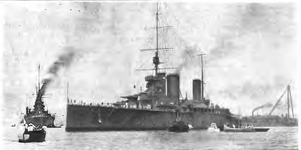
Флагманское судно англійской эскадры, сверх-дредноутъ „Лайонъ“ (Левъ), 27.000 тоннъ водоизмѣщенія; одна подводная часть его имѣетъ 4 сажени глубины.
