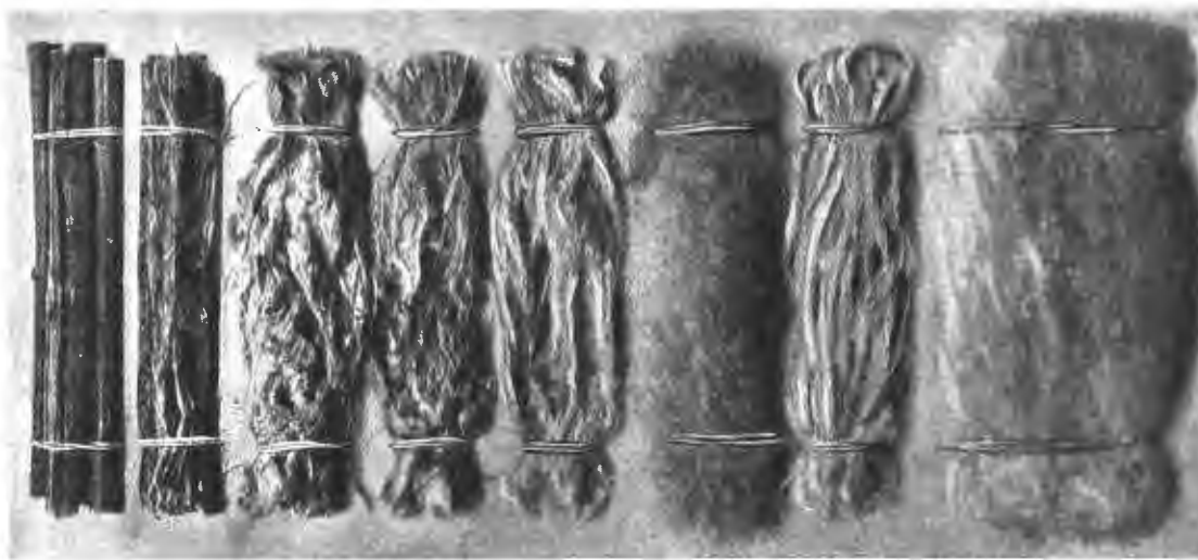
Стебли крапивы и выработанные из них волокна въ разныхъ степеняхъ ихъ обработки.
