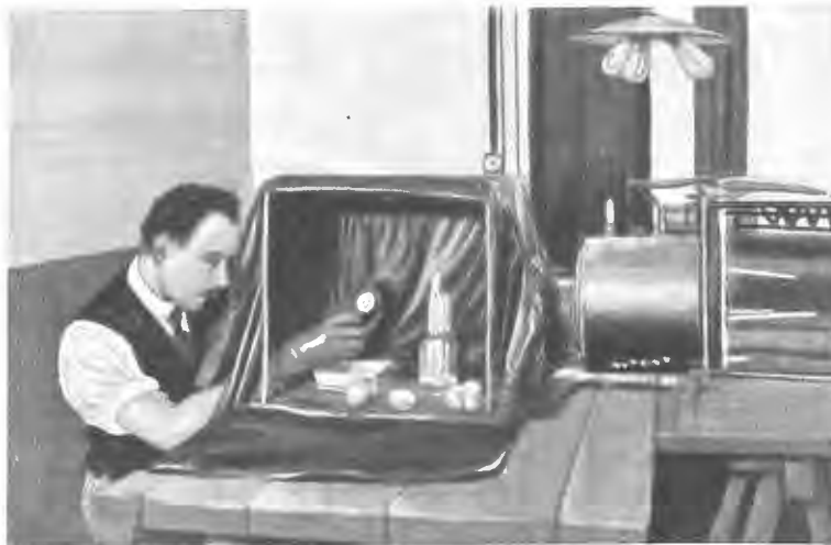
Рис. 1. Аппаратъ для безмикробной жизни; обезпложиваніе вводимыхъ яицъ.
