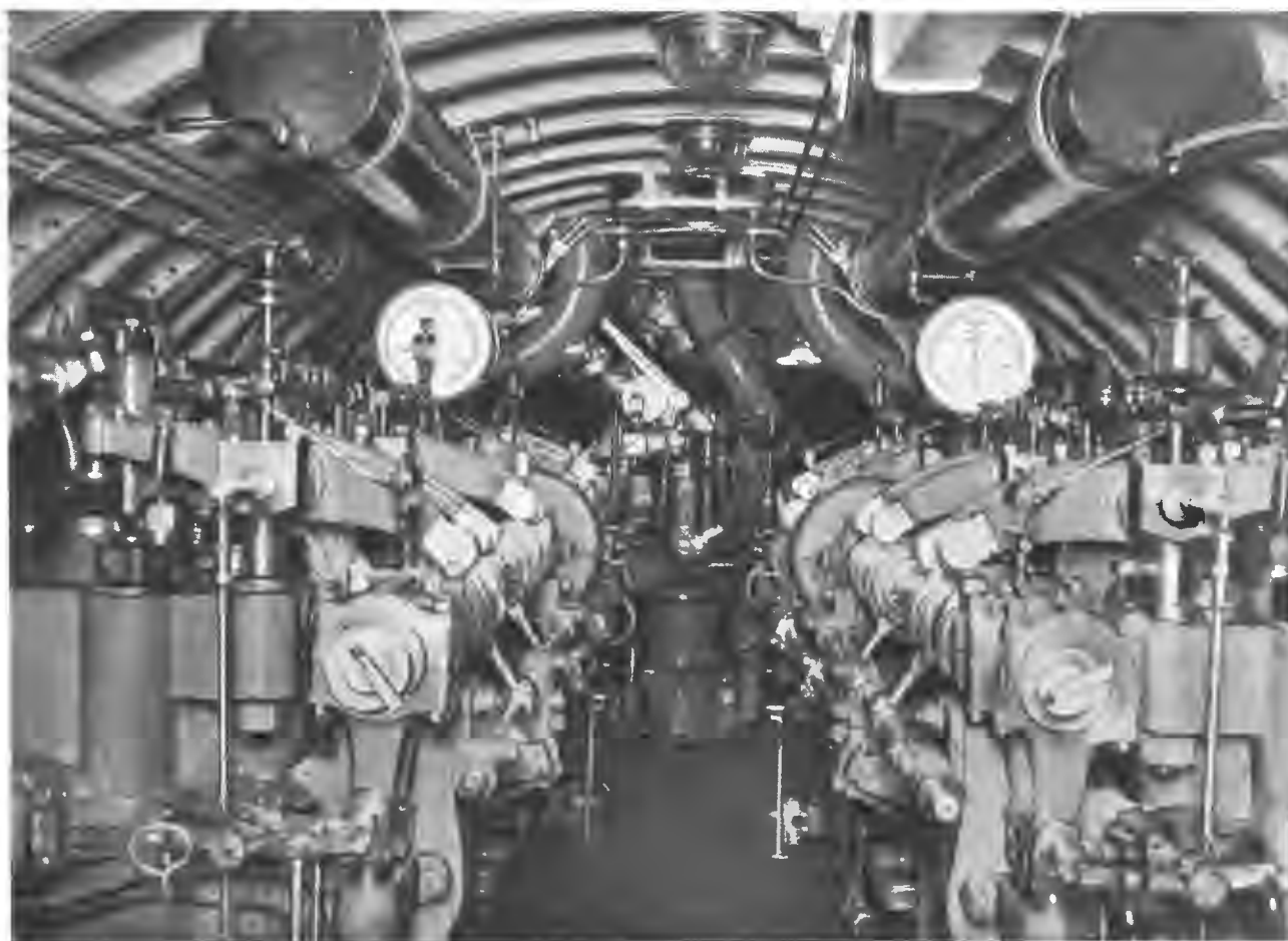
Внутренность подводной лодки. Машинное отделение, двигатель Дизеля.
