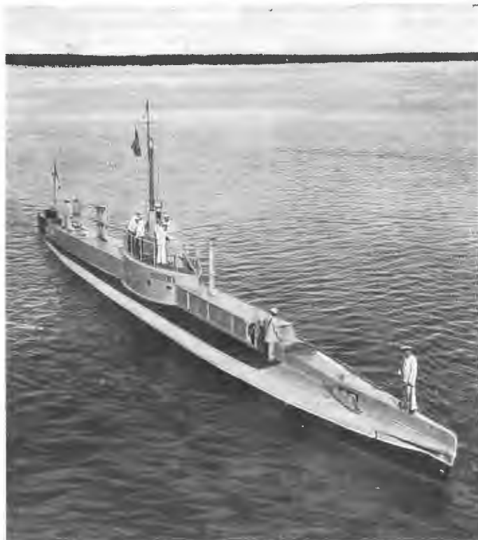
Подводная лодка системы Ленка—„Алигаторъ“ (450 тоннъ). Того же типа подводныя лодки „Кайманъ“, „Крокодилъ“ и „Драконъ“.
