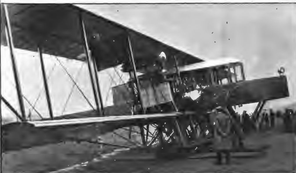
Аэроплан „Русский Витязь“ превзошел все существующие по своим колоссальным размерам, устойчивости и грузоподъемности. Веса до 250 пудов и снабженный четырьмя моторами в 100 сил каждый и огромными резервуарами для бензина и масла, „Русский Витязь“,—это смелое создание русского гения,—расчитан на безостановочный перелет до 2.500 верст. После ряда блестящих пробных полетов над столицей и окрестностями „Русский Витязь“ вполне оправдал ожидания его изобретателя: при полной нагрузке развивал скорость до 100 верст в час. На „Русском Витязе“ имеются особые каюты для пассажиров, могущих во время полета разгуливать по каютам и обозрывать окрестности „с высоты птичьего полета“.
