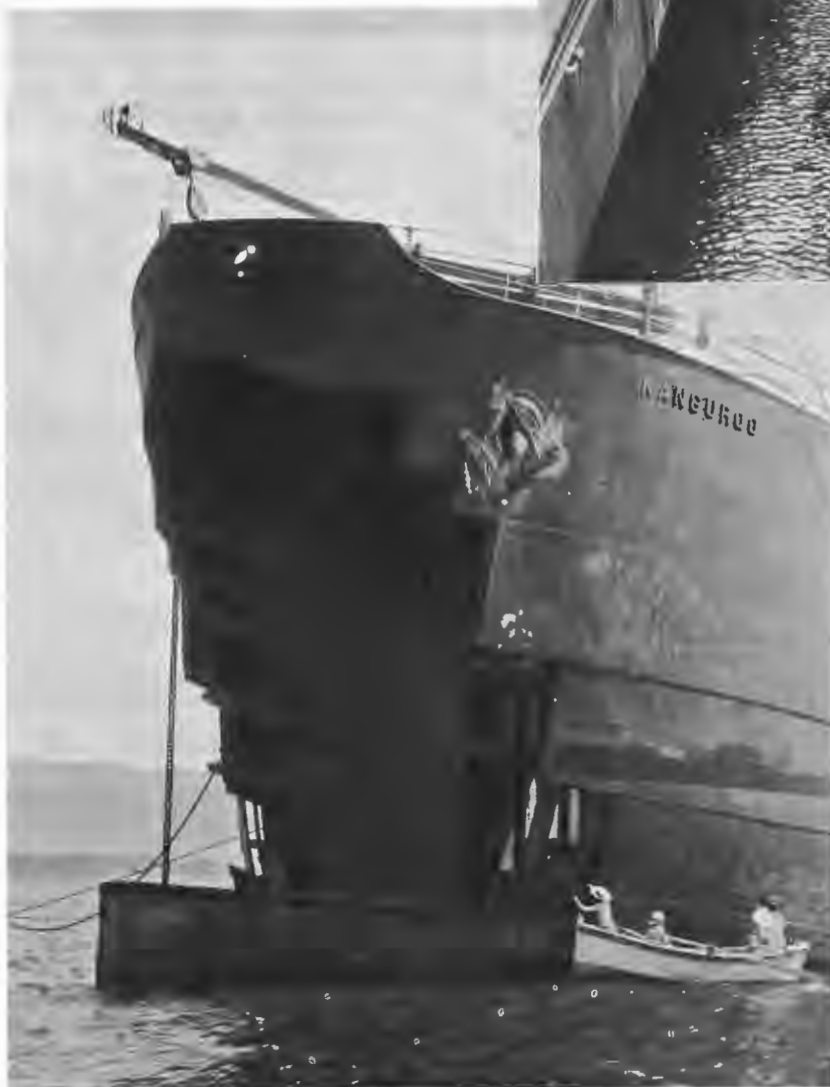
Транспортъ „Кенгуру“ до впуска воды во внутренней бассейнѣ. Входное отверстiе поднято надъ уровнемъ моря.
