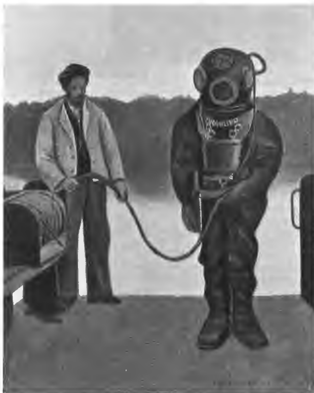
2. Внешний вид водолаза, вооруженного прибором для снабжения его воздухом, изготовляемым любекскою фирмою „Dräger-Werkes“.
