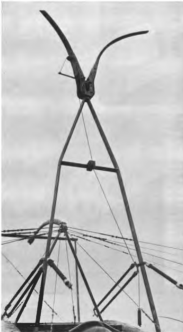
Система прицѣпки аэроплановъ. Видъ приспособленія, укрѣпленнаго на аэропланѣ.
