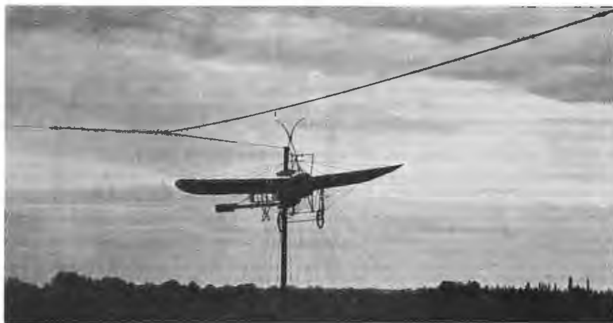
Система прицѣпки аэроплановъ. Аэропланъ готовится прицѣпиться къ канату, протянутому надъ полемъ.
