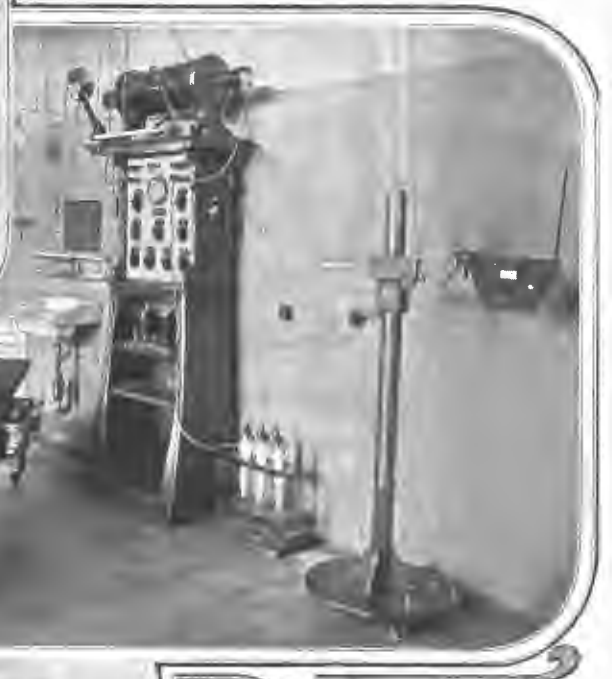
Рентгеновскій кабинетъ для изслѣдованія Рентгеновскими лучами. Большая Румкорфова спираль даетъ при разрядѣ искру въ 60 сантиметровъ длиною, могущую убить быка.
