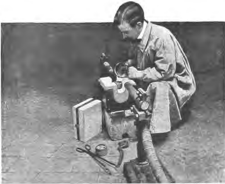
Загрузка материала в электрическую печь по снятии крышки.
