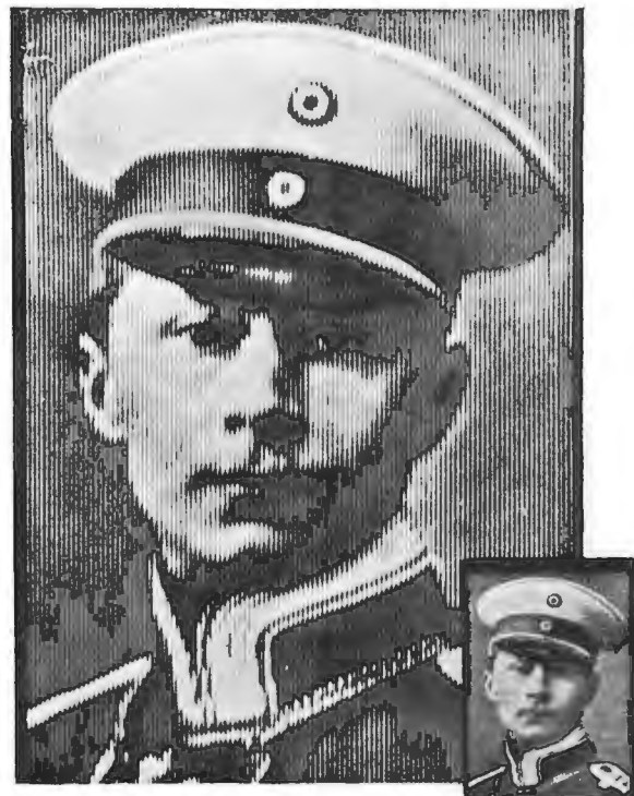
Портрет германскаго наследнаго принца, Фридриха-Вильгельма, переданный на разстояніе около 1800 верстъ окончательно усовершенствованнымъ приборомъ Корна. Рядомъ — тотъ же портретъ въ увеличенномъ видѣ: на немъ видны тѣ полосы, которыя представляютъ собою слѣды прѣхожденія лучей свѣта по негативу.
